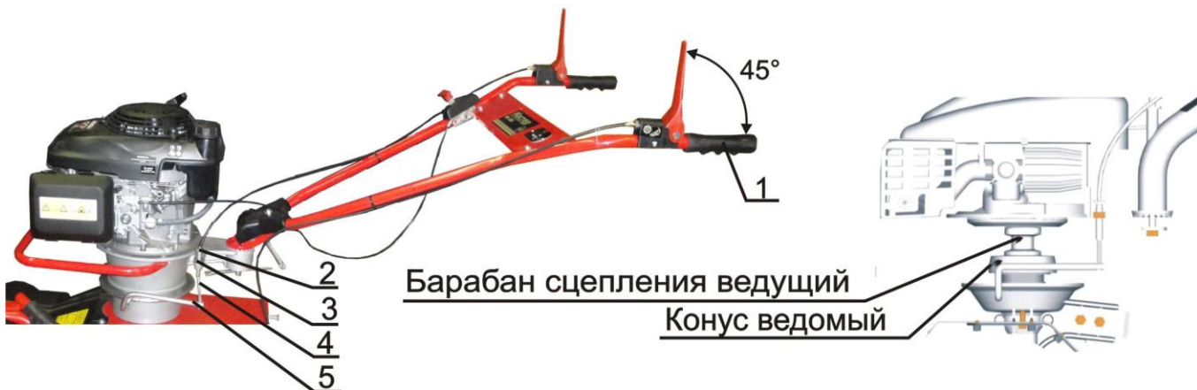
Рис. 6. Регулировка сцепления мотокультиватора
